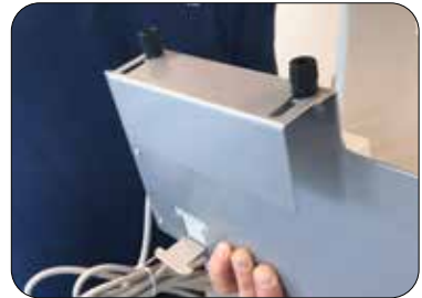
Draai de schroeven op de ophangbeugel los
