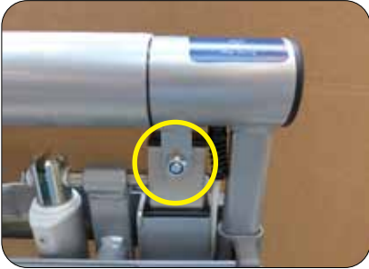
Demonteer de rolbuis van de draagarm voor de actuator
