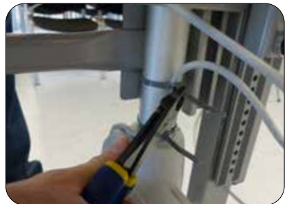
Knip het resterende deel van de kabelbinder af
