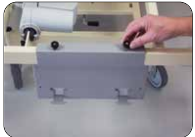
Fixeer de ophangbeugel door de 2 schroeven aan te draaien.
