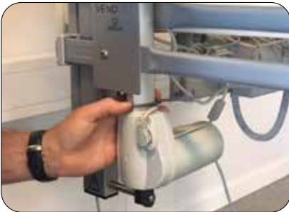
Bevestig de actuator kabel achter de actuator met kabelbinders
