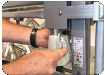
Vergrendel de connector met behulp van het vergrendelingsmechanisme
