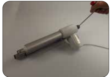
Verwijder inbuschroeven en koppel de aandrijfinrichting los
