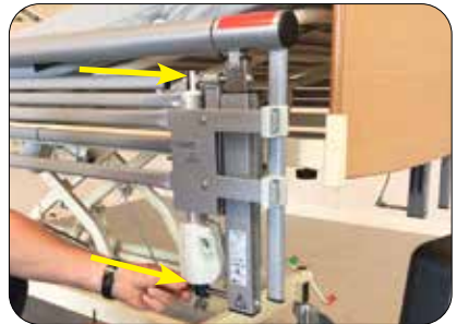
Schroef de bouten aan de boven- en onderkant vast
