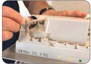
Steek de stekker in de besturingseenheid
